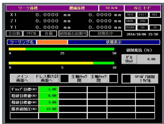
研削抵抗設定/監視画面(例) 研削抵抗の狙い値を入力、 研削抵抗をリアルタイムで表示
