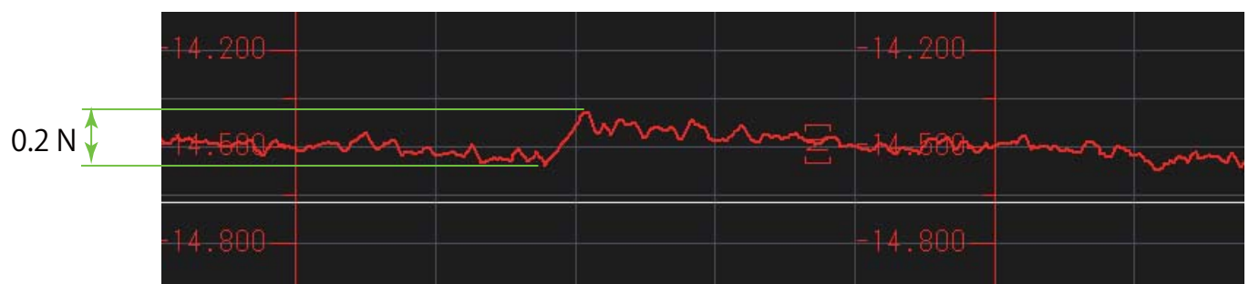
150000 min -1 で回転する砥石とドレスサとの接触抵抗の検出チャート
