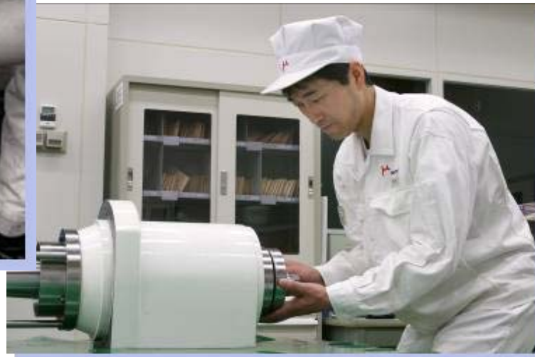
砥石軸ユニットの組付け作業
