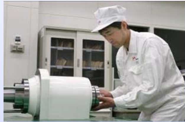
砥石軸ユニットの組付け作業
