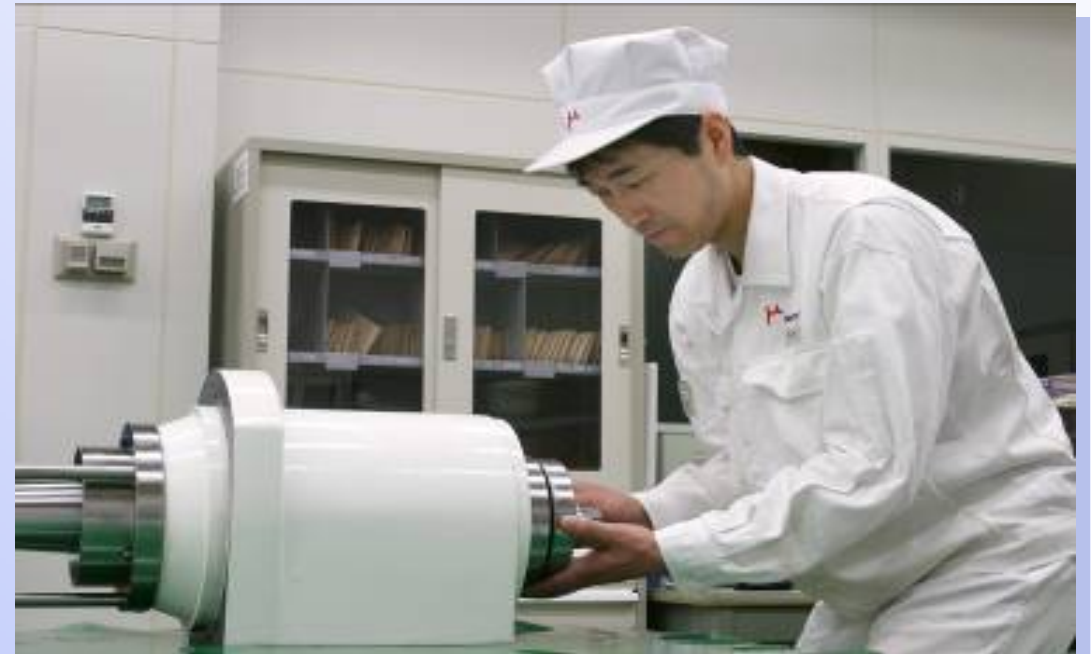
砥石軸ユニットの組付け作業
