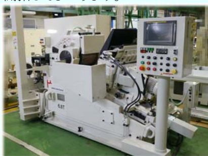
レトロフィット機として再生した心なし研削盤
