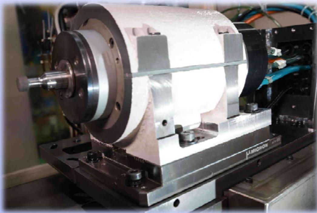
内面研削盤用動力計
